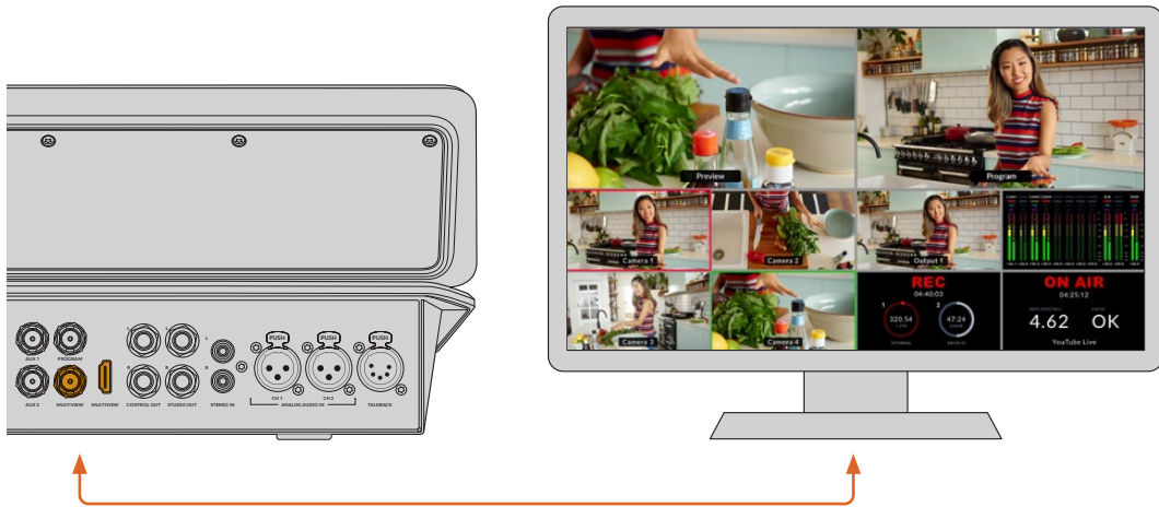
ATEM Television Studioスイッチャーをモニターに接続し、マルチビュー出力を確認
