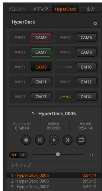
HyperDeckパレットのボタンを使用して10台までのHyperDeckを選択
