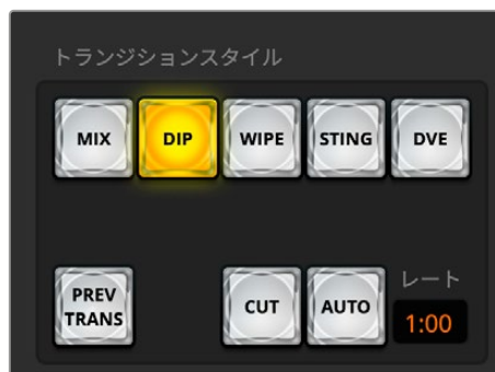
トランジションスタイルのセクションにある「CUT」トランジションボタン
