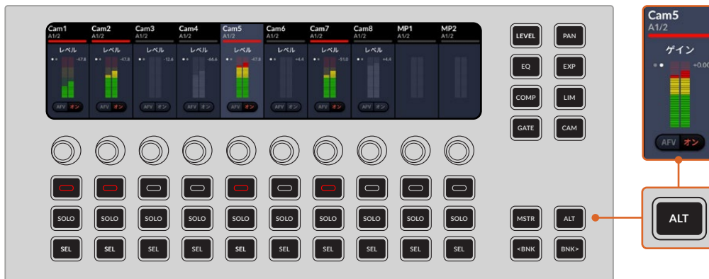
「ALT」ボタンを押してゲインコントロールを表示
